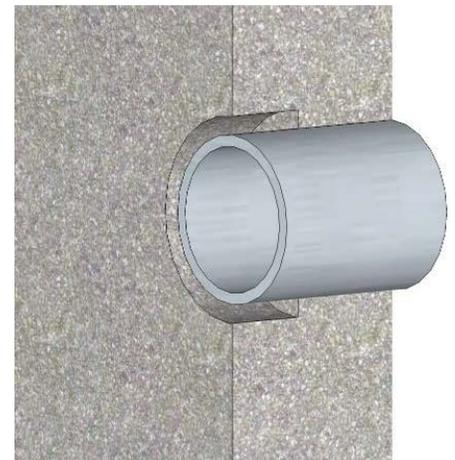
2. Lave el canal con agua hasta que el agua corra limpia. Use una aspiradora para eliminar el polvo, material suelto o el agua si es necesario.
